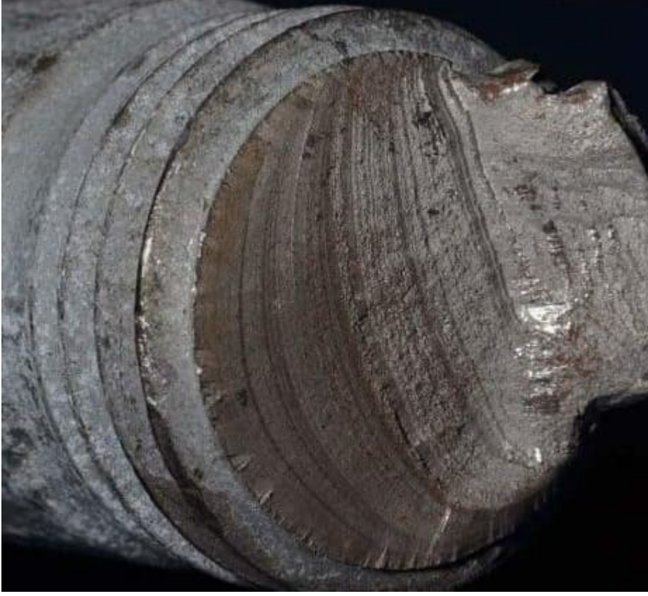
Şekil 1. Yorulma sonucunda kopmuş bir numune.
