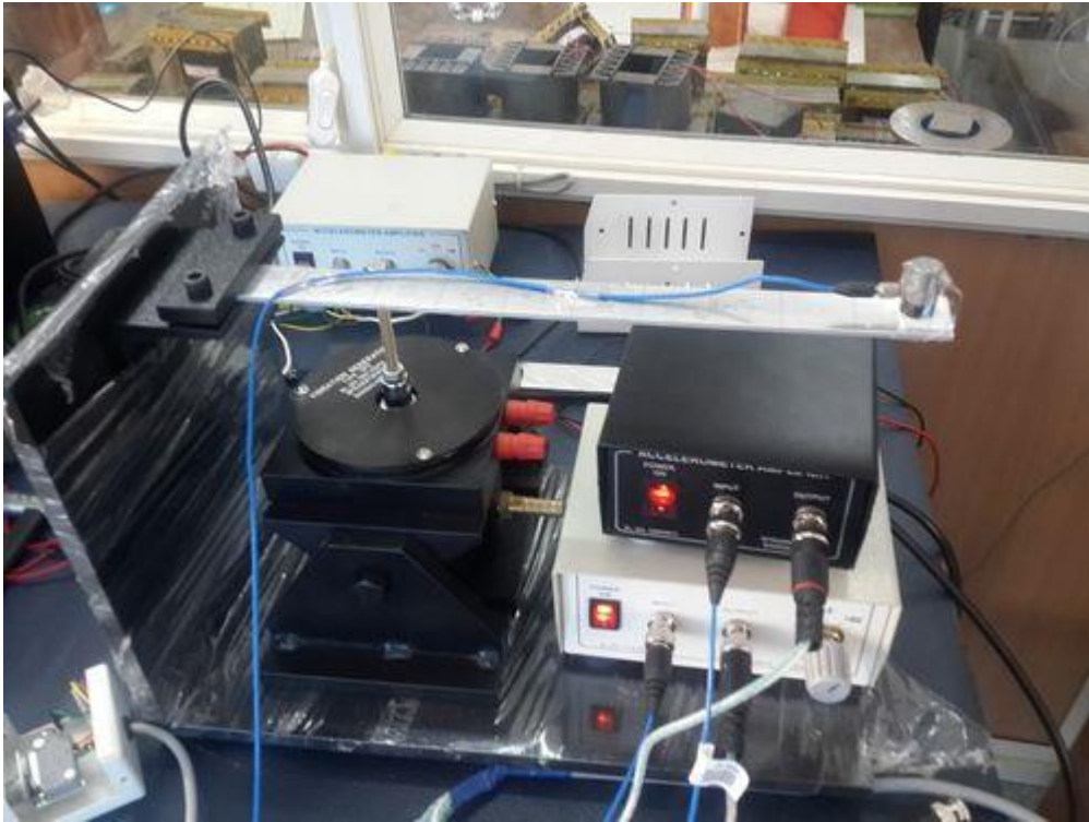
Şekil 6. Konsol Kiriş Titreşimi Deney Düzenegi
