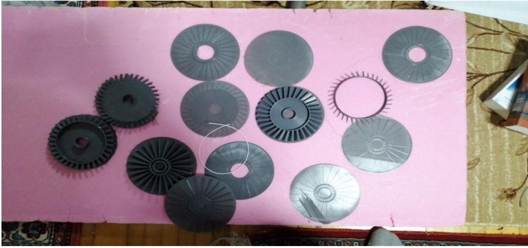
Şekil 60. Başarısız kompresör parçaları
