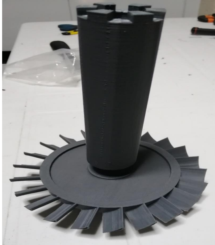
Şekil 71. Milin ucundan verilen havanın kanatlardan çıktığı deneme
