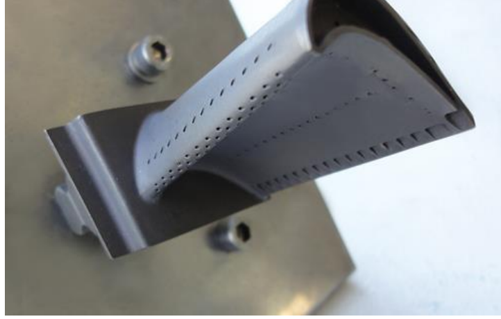
Şekil 29. Türbin kanadı soğutma delikleri
