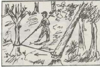
ŞEKİL - 28 Devrilmesi sırasında çevredeki herhangi bir yere dayanan ağacın çekme gücünden yararlanılarak düşürülmesi.
