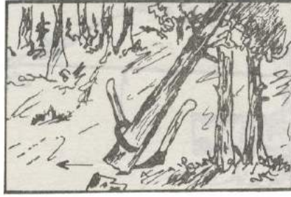
ŞEKİL - 27 Devrilmesi sırasında çevredeki herhangi bir yere dayanan ağacın sapın ve çevirme cengeliyle düşürülmesi.
