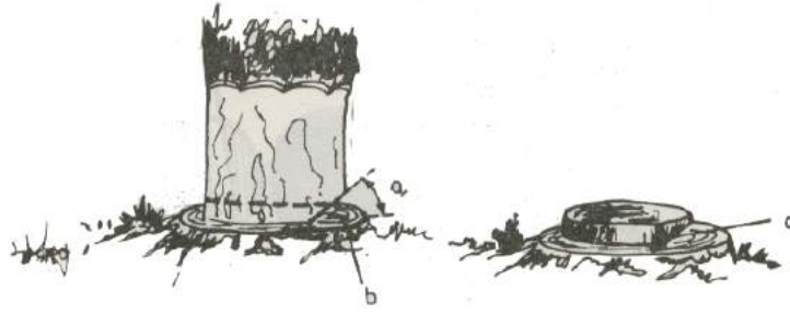
ŞEKİL-15 a = Devirme kertiği ağız açısı. b = Devirme kertiği tabanı. c = Devirme kertiği iç kenarı.
