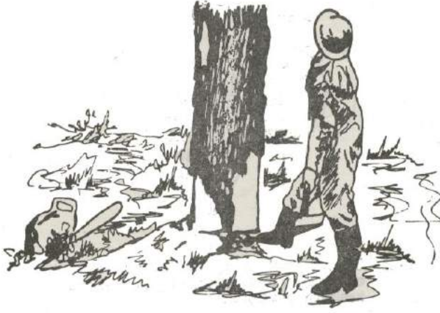
ŞEKİL-24 Motorlu testereyle yapılan kesimde kamaların çakılması.
